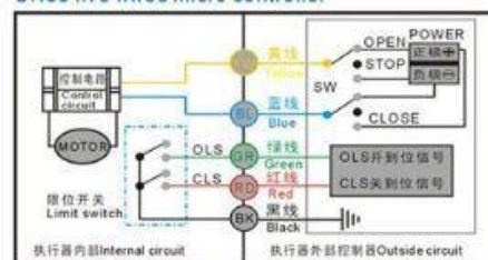
CR06(五线控制方式) CR06 Wiring diagram (five wires)
